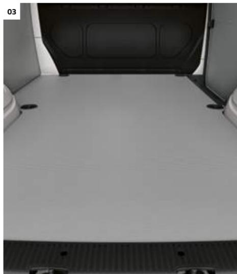
**03 Universalboden (für Ausbauten).** Schafft ideale Voraussetzungen für den nachträglichen Einbau von Schranksystemen verschiedener Hersteller.<sup>2)</sup> Spezielle Adapter<sup>3)</sup> in den Ausfräsungen im Bodenbelag ermöglichen einen jederzeit flexiblen Ein- und Ausbau von Schrankaufbauten ohne Kleben oder Bohren. Der Rückbau des Bodens hinterlässt nur minimale Spuren. | KA |
