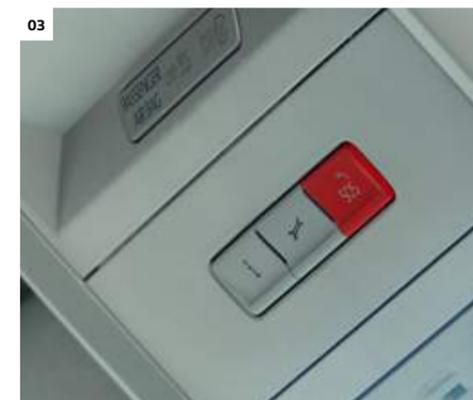
**03 eCall.** Übermittelt nach einem Unfall automatisch Zeit, Position und Anzahl der Insassen an die Notrufzentrale und stellt eine Sprachverbindung her. Aktiviert wird das System durch einen Crash-Sensor oder manuell über die Notruftaste. Ist ab dem Radiosystem „Composition Colour“ Serie. | KA | KO | KP | PR |
