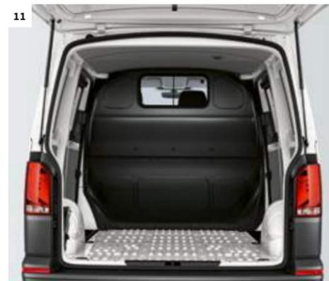
**10 Trennwand, hoch mit Fenster.** Das Fenster ist aus Sicherheitsglas. | KA | KO |
