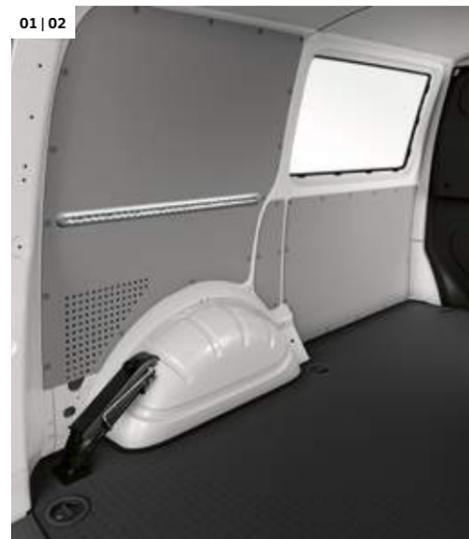
**01 Hohe Seitenverkleidung (Hartfaser).**<sup>1)</sup> Schützt die Seitenwände durchgängig vom Boden bis zum Dachrahmen. | KA | KO | KP |
